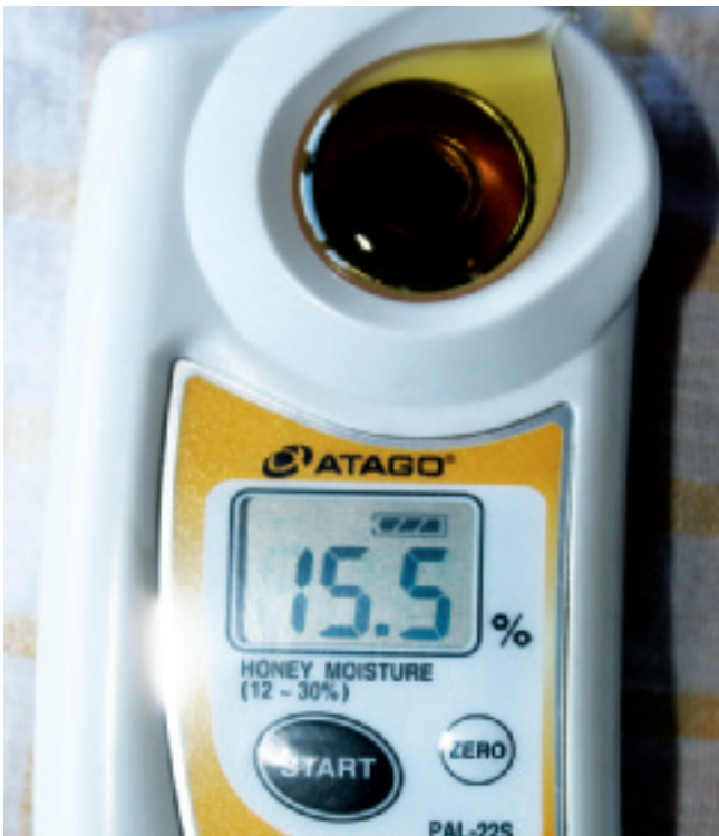
Abb. 2: Elektronisches Refraktometer, Wassergehalt eines sehr schönen Sommerhonigs.
