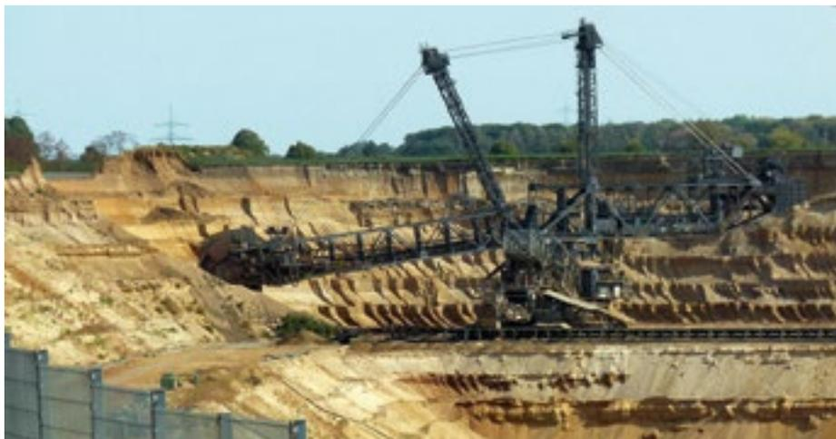
Abb. 06 - Der Schaufelradbagger trägt die Deckschicht ab.
