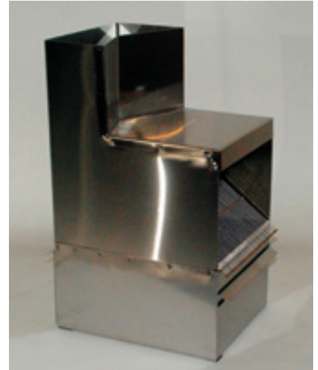
Abb. 03 - Der verwendete Separator zur Wachsabtrennung. Das Gerät passt unter die Bienenbroterntemaschine «Bee Bread Harvester BBM Mini». Foto: J.O. Adolph
