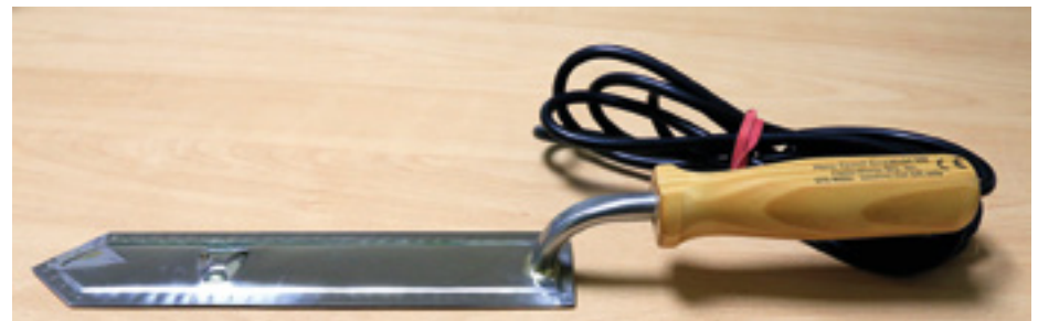
Abb. 12 - Elektrisch beheiztes Entdeckungsmesser (Pierce Speed King) mit Holzgriff der Firma Dadant. (Foto: Klaus Nowotnick)
