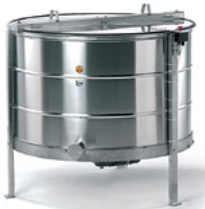
Abb. 05 - Radialschleuder für 60 Waben (Foto: Firma Carl Fritz).
