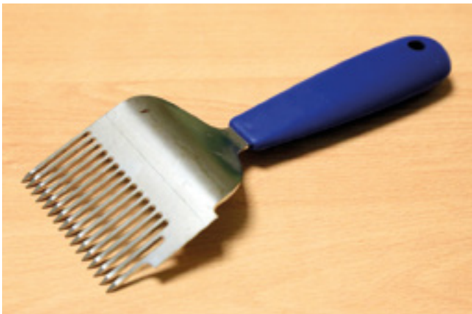
Abb. 17 - Entdeckungsgabel mit leicht nach oben gebogenen Nadeln. (Foto: Klaus Nowotnick)
