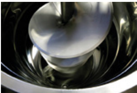
Abb. 10 - Blick in einen Rührkessel mit Schnecke mit einem Fassungsvermögen von 200 kg der Firma Carl Fritz. (Foto: Klaus Nowotnick)
