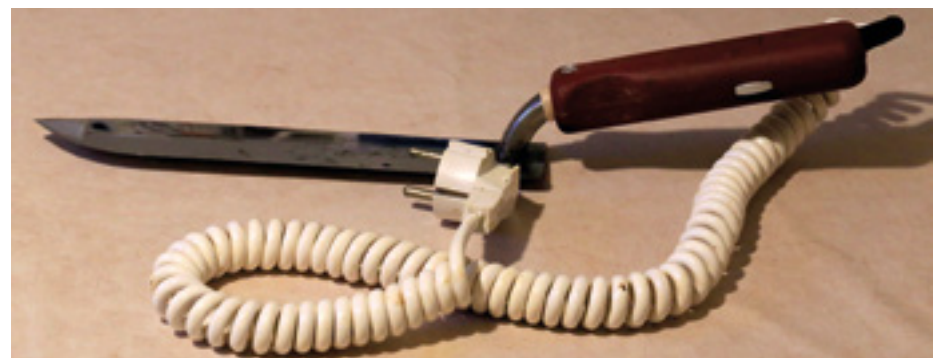
Abb. 14 - Elektrisch beheiztes Entdeckungsmesser mit Temperaturregulierungsrad am Handgriff aus Frankreich. (Foto: Klaus Nowotnick)
