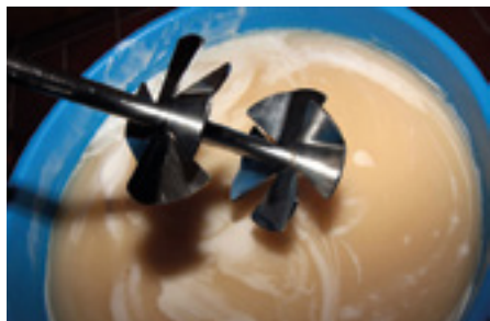
Abb. 06 - Mit einem Rührflügel, der in eine starke Bohrmaschine eingespannt ist, kann man auch Honig cremig rühren. (Foto: Klaus Nowottnick)
