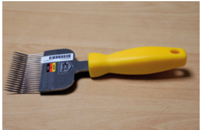
Abb. 18 - Gebogen und gekröpfte Nadeln sind Kennzeichen dieser Entdeckungsgabel. (Foto: Klaus Nowotnick)
