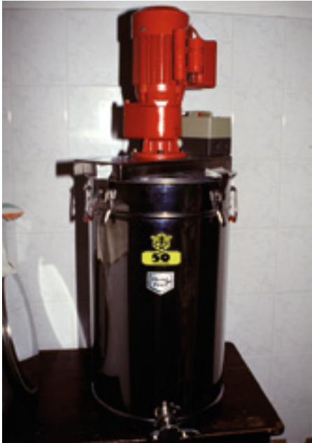
Abb. 09 - Rührgerät mit 50 kg Honigkessel. Der Rührrechen mit durch einen auf der Traverse sitzenden Getriebemotor bewegt. (Foto: Klaus Nowotnick)
