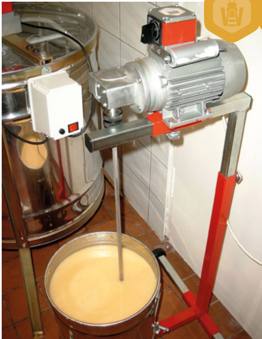
Abb. 07 - Rührgerät der Firma Ruck. (Foto: Klaus Nowottnick)
