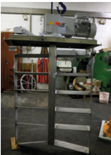
Abb. 11 - Rührrechen für einen Rührbehälter mit 1000 kg Fassungsvermögen in der Firma Carl Fritz. (Foto: Klaus Nowotnick)
