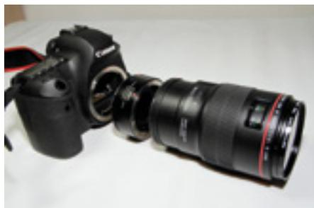
Abb. 03 - Kamera mit Zwischenring EF 25 mm und Makroobjektiv 100 mm an einer Canon 6D. Foto: Klaus Nowotnick
