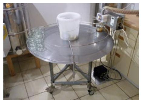
Abb. 09 - Mit Drehteller und Abfüllmaschine macht das Abfüllen größerer Honigmengen wieder Spaß.
