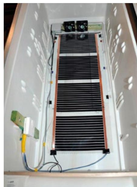
Leider zeigte sich beim ersten Probebetrieb, dass der Temperaturunterschied zwischen oberem und unterem Fach durch Konvektion nicht zu vernachlässigen ist. Während der Eimer im oberen Fach mit Blütenhonig schon fast flüssig war, machte der Eimer im unteren Fach nur einen leicht angewärmten Eindruck. Wir entschlossen uns mittels Temperaturmessung die Situation messtechnisch zu erfassen. Auf alle Fälle wollten wir eine Überhitzung des Honigs vermeiden.
