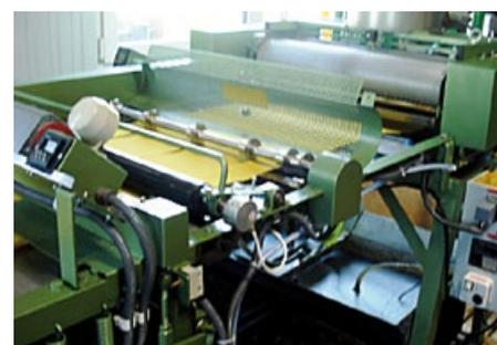
Abb. 11 - Automatische Mittelwand-Produktion in einem Wachsverarbeitungsbetrieb.
