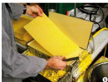
Abb. 6 - 9 - Mittelwände gießen in vier Schritten: 1. Lösemittel aufs Scharnierband; 2. Befüllen; 3. Während der Abkühlphase wird die Vorderkante gesäubert; 4. MW entnehmen, fertig.
