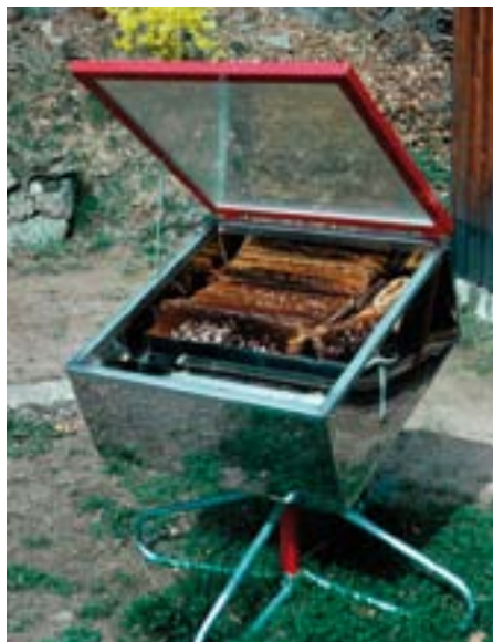
Abb. 03 - Drehbarer Sonnenwachsschmelzer aus Edelstahl im Betrieb..
