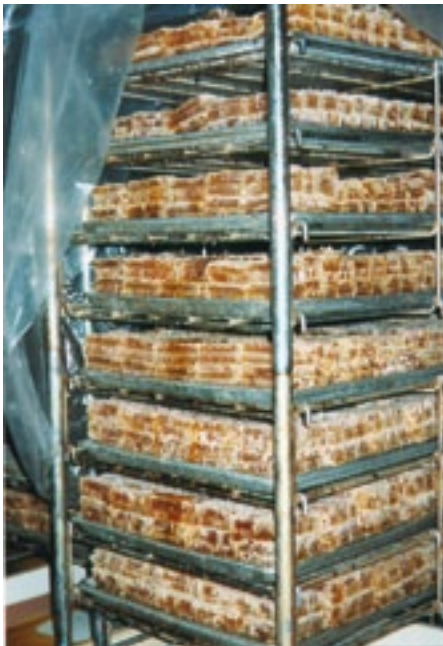
Abb. 18 Professionelle Wabenhonigverarbeitung in einem großen Abfüllbetrieb in Florida. Hier ein Abtropfregal
