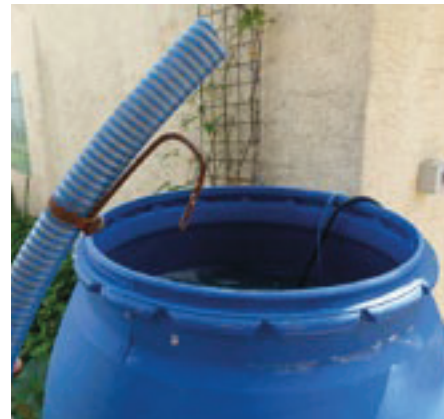
Abb. 07 und Abb. 08 - Mit Kugelventil und Spiralschlauch können die Kanister schnell befüllt werden – ein Haken am Schlauchende zum Einhängen am Fassrand ermöglicht kleckerfreies Arbeiten.
