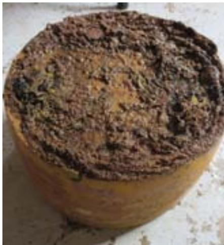
Abb. 13 - So sieht der Boden eines Wachsböckes nach dem ersten Einschmelzen für gewöhnlich aus – diese Schicht wird großzügig mit dem Stockmeißel entfernt, bevor der Wachsböck ggf. zur weiteren Reinigung nochmals aufgeschmolzen und durch ein Stoffgewebe fein gesiebt wird (nur für die Kerzenherstellung erforderlich!).
