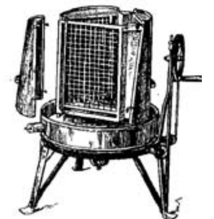
Abb.04 - Alte Honigschleuder ohne geschlossenen Kessel.
