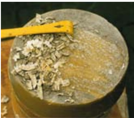
Abb. 07 - Säubern der flachen Wachs-kuchen vor dem erneuten Einschmelzen zur weiteren Reinigung des Wachses.
