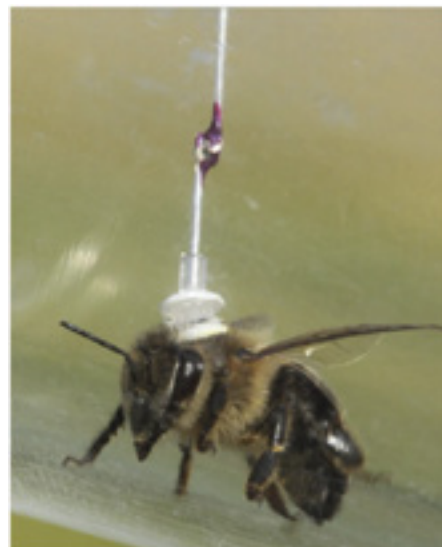
Abb. 05 - Eine Biene erhält einen Transponder, so lässt sich ihr Flug über Radar orten. (Foto: Prof. Dr. Randolph Menzel)
