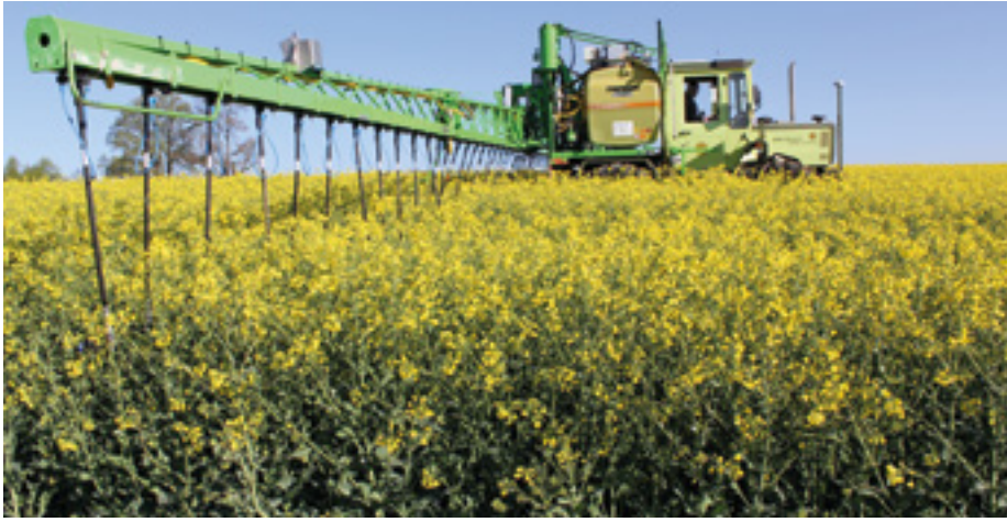
Abb. 08 - Bei der Durchfahrt mit abgesenkten Droplegs.
