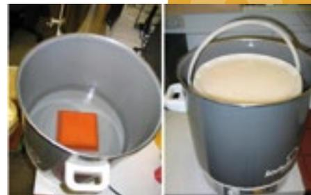
Abb. 14 - Wiederverflüssigen im Wasserbad: Einstellen des Vorratsbehälters ins Wasserbad auf eine Unterlage, Deckel muss dicht sein, nicht über 40°C erwärmen.
