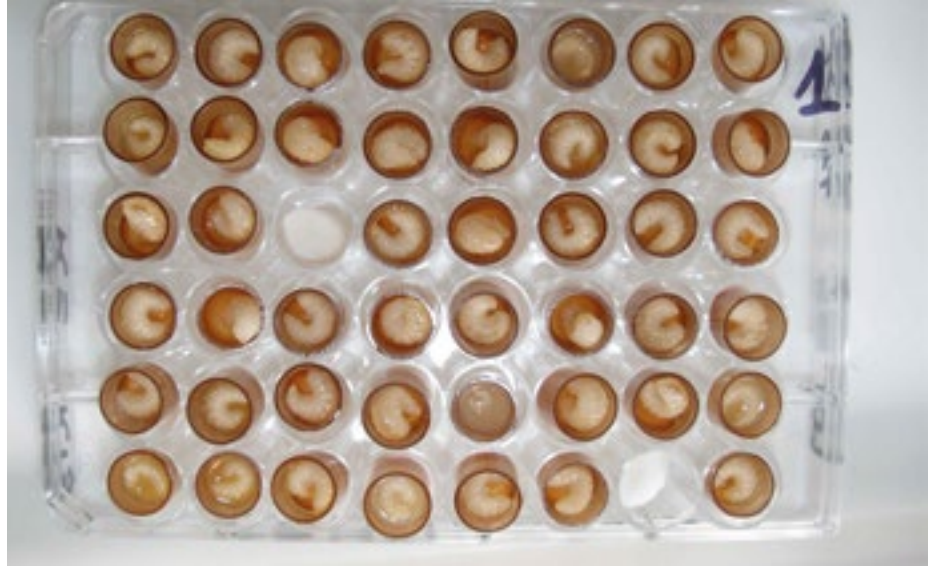
Abb. 01 - Bruttest im Labor. Larven werden mit wirkstoffversetztem Larvenfuttersaft aufgezogen.
