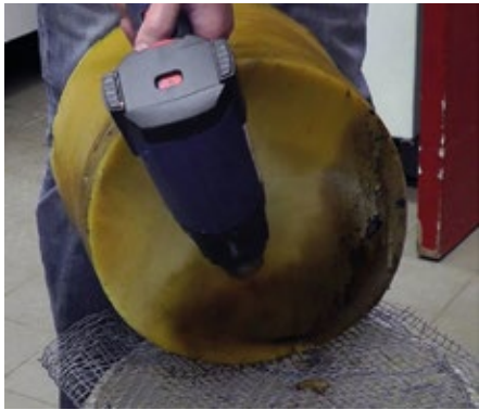
Abb. 10 - Mit einem Heißluftfön lässt sich die Schmutzschicht am Boden des fertigen Wachsklotzes leicht in einen untergestellten Eimer mit Müllbeutel abschmelzen.
