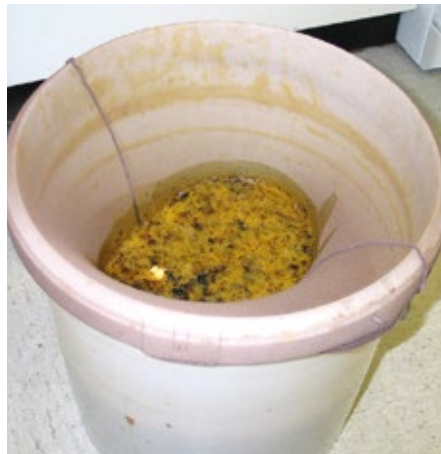
Abb. 07 - Den kochenden Wachs-Wasser-Dreck-Sud vorsichtig in einen leeren Strumpfhosensieb-Eimer gießen. Der Eimer kann ganz voll sein. Er platzt nicht.
