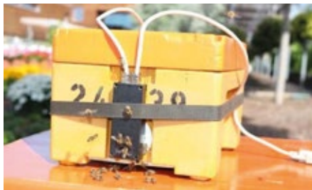
Abb. 02 - Wie lange gehen Bienen auf Sammelflug? Mit dem Einsatz von modernster Technik am Bienenvolk lässt sich diese Frage bald beantworten. Denn ausgestattet mit RFID-Chips wird das Flugverhalten der Pollensammler, ähnlich einer Black-Box, künftig elektronisch erfasst.
