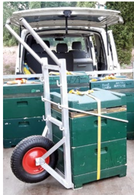
Abb. 13: Der Clou der Beutenkarre ist der Bügel, der nur umgelegt werden muss, um die Bienenbeute zu sichern. Hier die Neuauflage der Beutenkarre in Alu, die wesentlich leichter ist als die Stahlrohrvariante. (Foto: Horst Schäfer)
