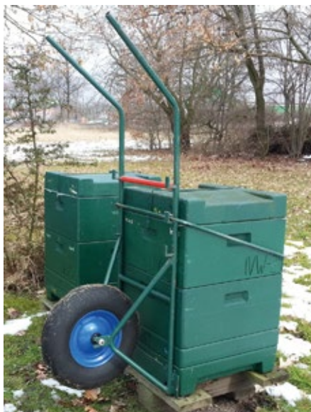
Abb. 12: Beutenkarre aus Stahlrohr, dabei lege ich besonderen Wert auf ein Rad mit Rollenlager, immerhin kann das Gewicht einer Beute mit eingetragenen Honig 80 kg betragen. (Foto: Horst Schäfer)
