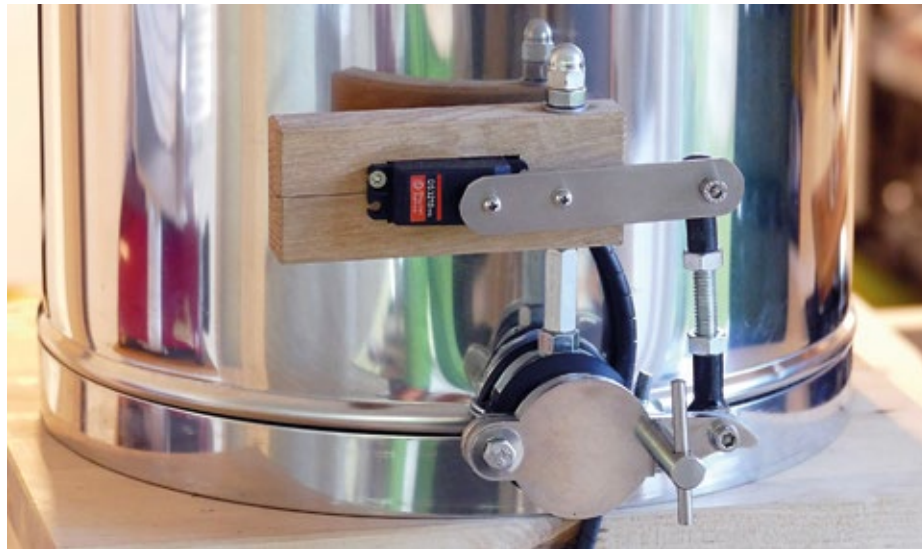
Abb.4 - Servohalter aus Holz mit Schraubschelle. (Andreas Holzhammer)
