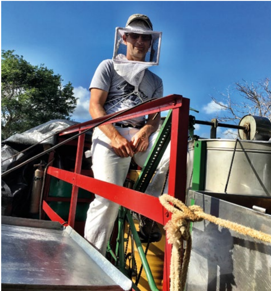
Abb. 03 - Steve Andrijiv auf einem Fahrradrahmen, dass die Honigschleuder in Drehung versetzt.
