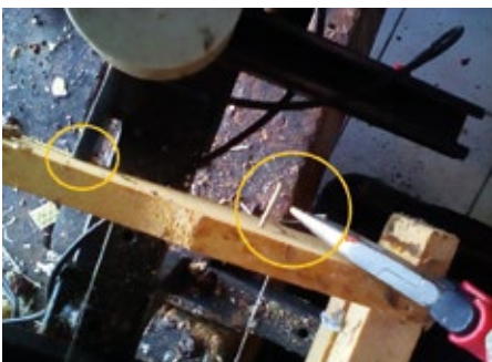
Abb. 04 - Mit dem Rähmchenspanner werden beide Seitenteile eingedrückt, Draht wird somit locker und kann leicht mit der Hand und mithilfe einer Spitzzange ange-spannt werden. Draht wird wieder am Nagel umwickelt befestigt.
