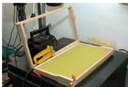
Abb. 11 - Einlöten der Mittelwände mittels Einlötrafo, Wabenspanner
