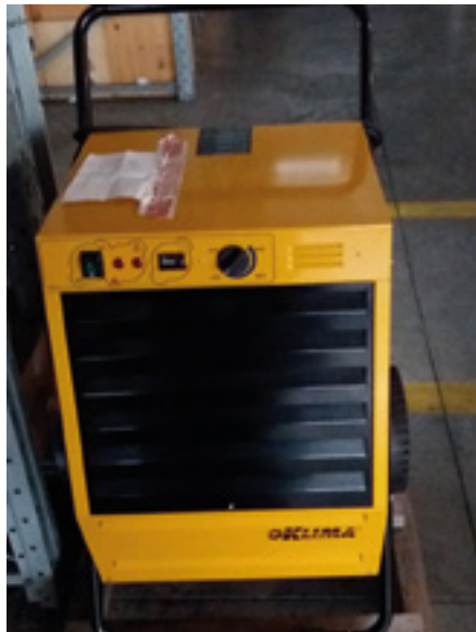
Abb. 13 - Ein Lufttrockner gehört zur Standardausrüstung einer Imkerei.
