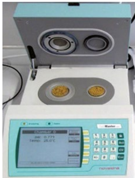
Bild 5: Gerät für die Bestimmung der Wasseraktivität
