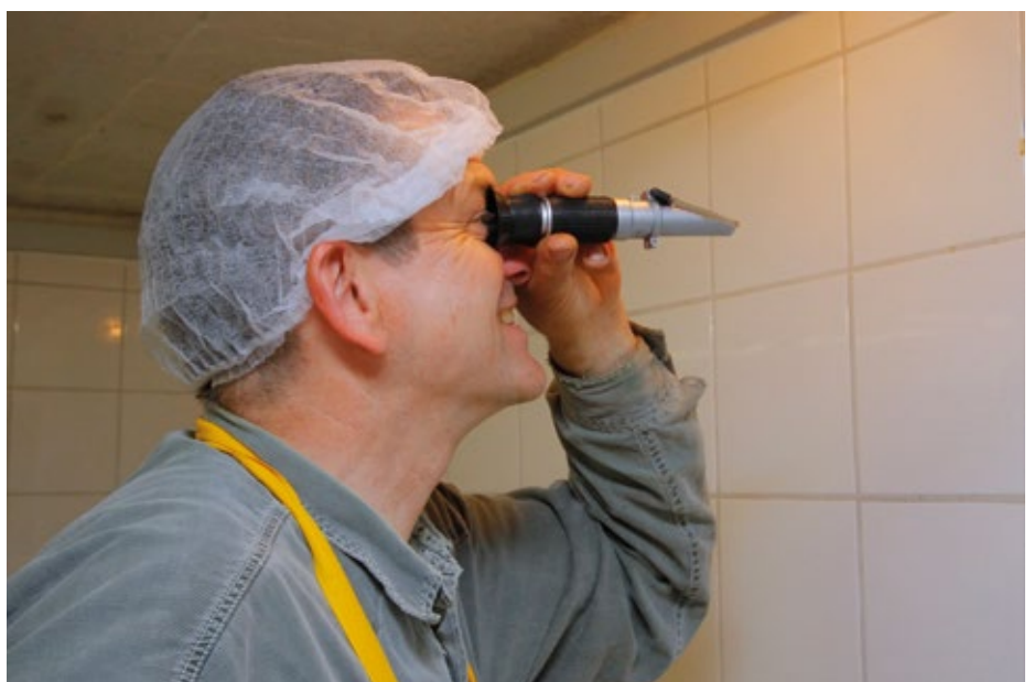
Abb. 02 - Genauer lässt sich der Wassergehalt im Honig mit einem Refraktometer bestimmen. Foto: H. Schäfer
