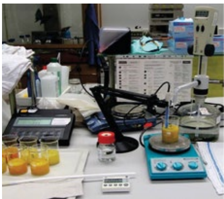
Bild 4: Bestimmung der Gehalte von freier und gebundener Säure durch Titration
