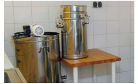
Abb. 13 - ...Anschließend fließt der Honig durch den Feinfilter. Der Siebkübel hat einen oberen Auslaufhahn, damit die Schwabeteile (Wachsreste) oben aufschwimmen und nicht das Feinsieb zusetzen. Foto: H. Schäfer
