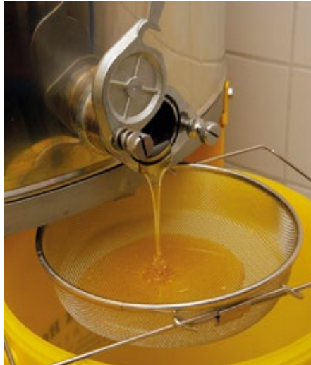
Abb. 12 - Der Honig fließt aus der Schleuder zunächst nur durch ein Grobsieb. Foto: S. Rübensaat
