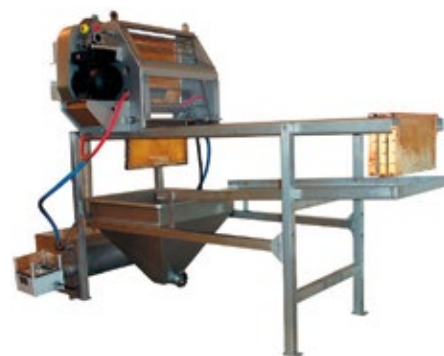
Abb. 13 - (Foto: Paradise Honey Ltd., Kerkkoo Finland) Entdecklungsmaschine S3B, die 12 Rahmen auf einmal aufnehmen kann und 11 Waben pro Minute entdeckelt
