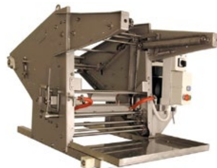
Abb. 12 - (Foto: Paradise Honey Ltd., Kerkkoo Finland). Entdecklungsmaschine S1B mit kompletten Zubehör.
