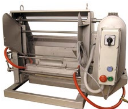
Abb. 11 - Paradise Honey Ltd., Kerkkoo Finland) Professionelle Entdecklungsmaschine S1B mit der sich 8 Waben pro Minute entdeckeln lassen
